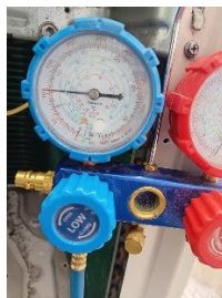
Medición de parámetros de corriente y presión después del mantenimiento
