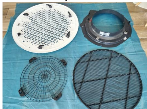
Accesorios de evaporadora después del mantenimiento
